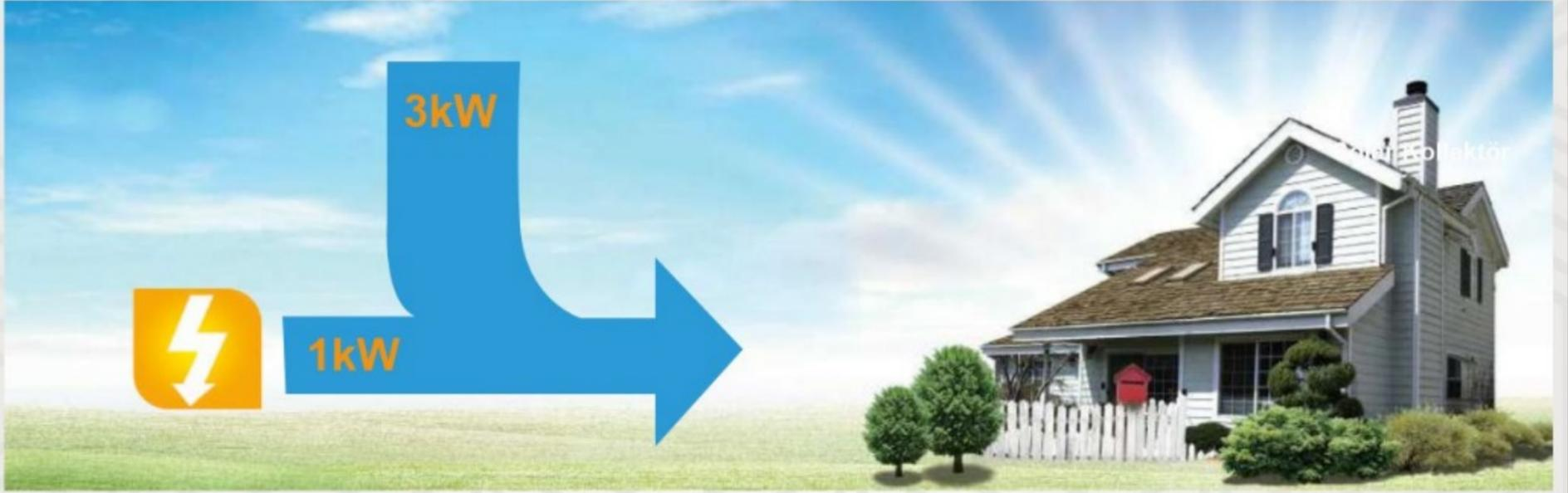
Isı pompaları dışarıdan verilen enerji ile ortamdan alınan ısıyı başka bir ortama aktaran cihazlardır. Isı pompası ürünleri ile mahal ısıtması, mahal soğutması, havuz suyu ısıtma veya soğutması ve kullanım sıcak suyu elde edilmesi gerçekleştirilebilir. Isı pompaları, ters soğutma çevrimi prensibi ile çalıştığından sistemde tüketilen enerji miktarı çok azdır.
